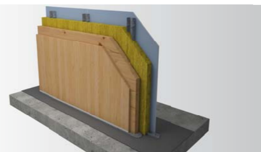
DEK VNITŘNÍ NOSNÁ STĚNA SN.0007E (DEKPANEL D 2.1.3) z panelů DEKPANEL, povrchy malba na sádkartonové akustické desce / biodeska
