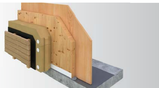
DEK OBVODOVÁ STĚNA SN.0006B (DEKPANEL D 1.3.3) z panelů DEKPANEL, s ETICS, dřevolákno, s ověřenou požární odolností, vnější povrch tenkovrstvá pastovitá omítka, vnitřní povrch biodeska
