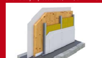
DEK VNITŘNÍ NOSNÁ STĚNA SN.0009A s volně stojící předstěnou, MW, SVD + malba
