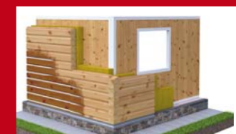
DEK OBVODOVÁ STĚNA SN.5001B s roubením, s vloženou izolací, MW, palubky / dřevěné roubení
