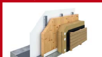
DEK OBVODOVÁ STĚNA SN.0005A zat. sys. větrání, dřevovláknno, SDK + malba / obklad z dřev. palubek
